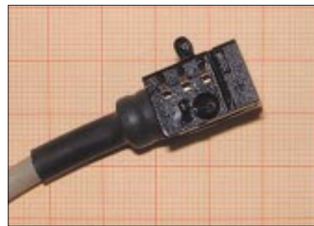
Bild 3: Datenkabel für Garmingeräte (hier nur Anschlüsse für Minus, Data in, Data out)
