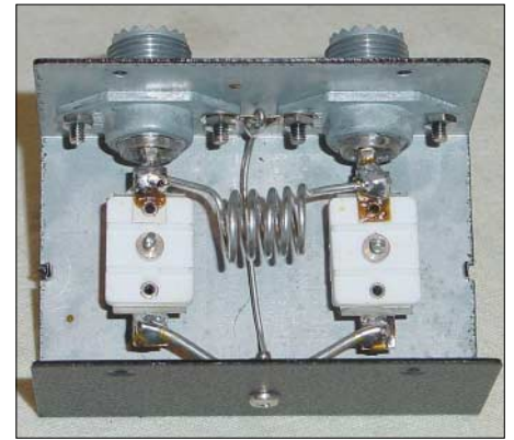
Bild 7: Die umgebaute CB-Matchbox von innen, die Induktivität wurde wie angegeben verringert. Fotos: DK7ZB
