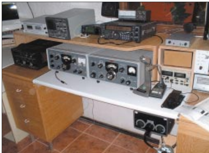
Bild 1: Collins-Line bei EA8AZC, links Sender, rechts Empfänger. Links neben dem Sender steht noch ein uralter Dentron Linear-Verstärker, der jedoch nicht angeschlossen ist.
