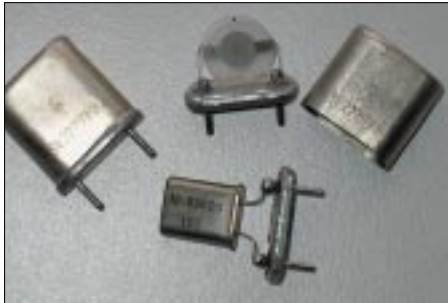
Bild 2: Nach Absägen der Kappe des HC 6/U-Gehäuses lässt sich das Quarzplättchen entfernen und an seiner Stelle ein HC 18/U-Quarz auflöten.
