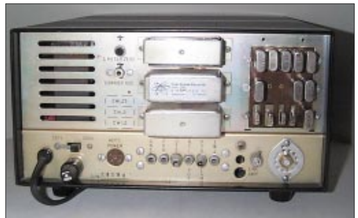
Bild 3: Rückseite des R4C; rechts oben sind die Steckplätze für die Quarze zu erkennen (Schutzdeckel abgenommen). Fotos: DL2TS
