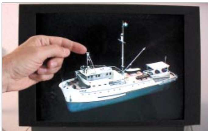
Das Akkommodationsdisplay: Virtuelle Objekte schweben frei vor dem 3D-Monitor und können dort durch Handgesten „manipuliert“ werden.
