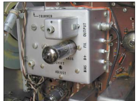
Bild 2: VFO des HW101. Hier ist die C-Diode für die DAFC nachzurüsten. Fotos: DL8WA
