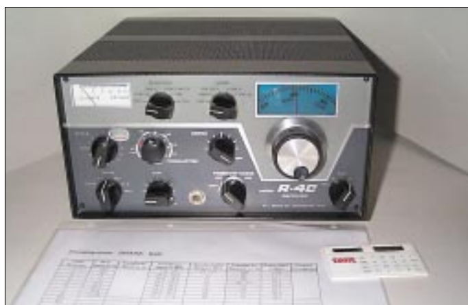
Bild 1: Frontansicht des R4C; unterhalb des S-Meters ist das kleine ovale Fenster zum Beschriften nachgerüsteter Frequenzbereiche zu erkennen. Im Vordergrund liegen Tabelle und Taschenrechner zur Frequenzumrechnung.
