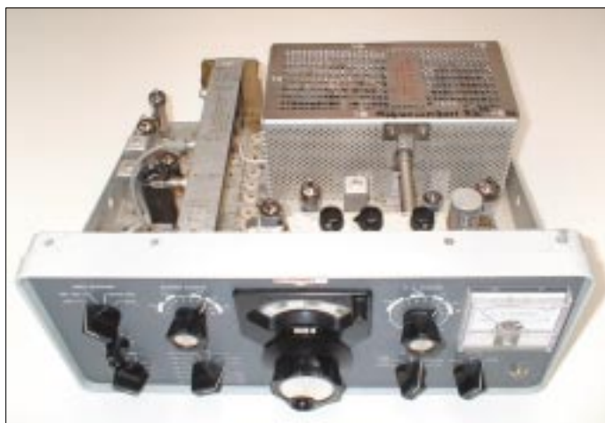
Bild 4: Innenleben des Collins-Senders. Deutlich sichtbar die PA mit zwei 6146-A Röhren bestückt, Ausgangsleistung etwa 120 W PEP Fotos: EA8AZC
