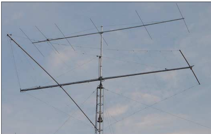
Bild 1: Selbst bei vorhandener 6-m-Langyagi – hier die Antennenanlage bei DK7ZB – kann eine für 6-m-Betrieb „entfremdete“ KW-Antenne als „Suchantenne“ dienen (siehe Text).
