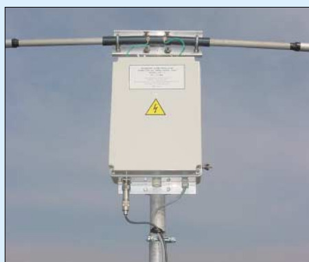
Bild 4: Fernabstimmbarer, symmetrisch aufgebauter Antennentuner AG-3 am Speisepunkt eines selbstgebauten Drehdipols [2] Fotos: DK7ZB (2)
