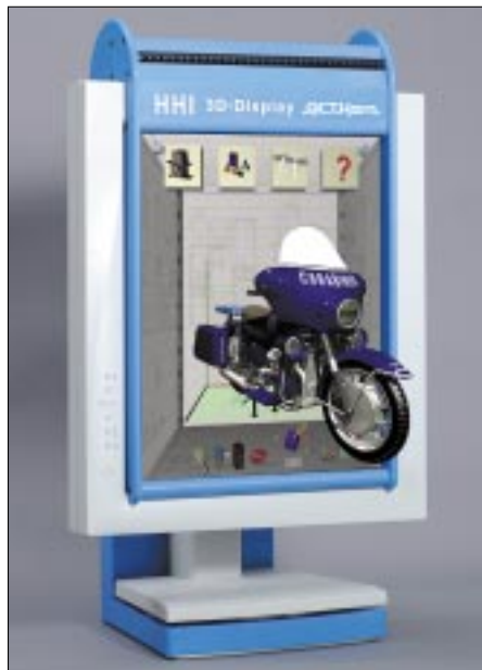
Neuartiges hochauflösendes 3D-Display für gemischt-reale Anwendungen
